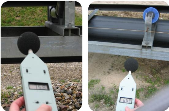
El rodillo de transporte TQ amortigua cualquier sonido tanto del revestimiento como del bocal del cojinete. Eso puede implicar una reducción de ruido de por lo menos 10 dB (A). Gracias a la fundición inyectada del revestimiento, éste es perfectamente redondo, al contrario de un rodillo de acero, en el cual la junta de soldadura produce un aumento del espesor.
