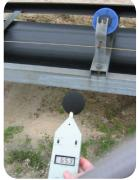
Devido ao seu revestimento em aço e às próprias caixas de rolamentos, os rolos em aço são caixas acústicas que amplificam todos os ruídos. O rolo TQ abafa todos os ruídos, tanto no tubo como na caixa de rolamentos. Este factor permite reduzir o ruído em cerca de 10 dB (A).
